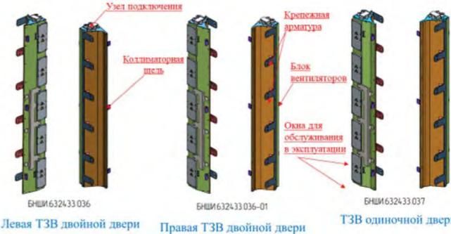
Рис. 6. Внешний вид воздушных тепловых завес
