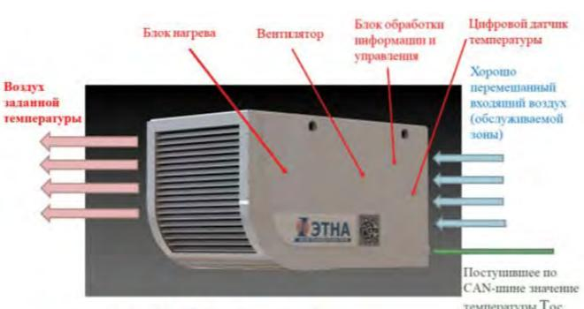
Рис. 2. Ключевой компонент мультизонаной системы климат-контроля – адаптивный отопитель салона
