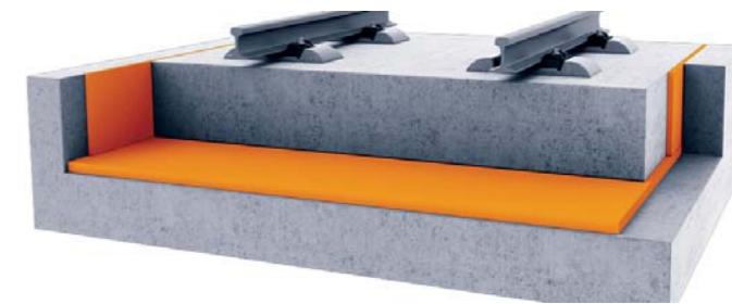
Система «масса-пружина» с полноплоскостной опорой
