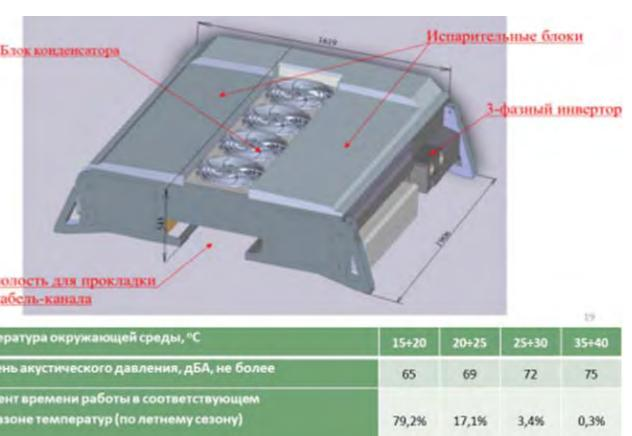
Рис. 7. Кондиционер с холодопроизводительностью 42 кВт с встроенным 3-фазным инвертором (600/380В) и 3-мя низковольтными инверторами (600/24В), со схемой управления тепловыми воздушными завесами
