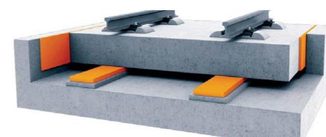
Система «масса-пружина» с ленточными опорами
