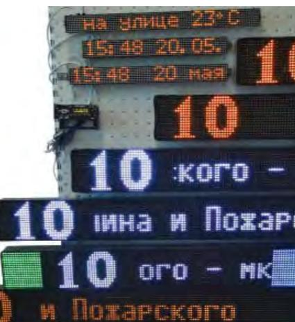
Маршрутный информатор на базе табло с шагом светодиодов модуля 10мм TMC0630-10Z-1-N с бегущей строкой BC-1111. BC-1112, BC-1113 (для ПАЗ ВЕКТОР НЕКСТ)
