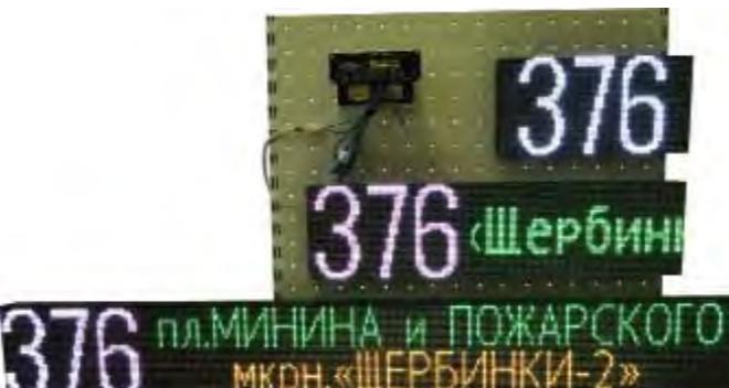
Маршрутный информатор на базе табло с шагом светодиодов модуля 6мм TMC-0630-6Z-1N
