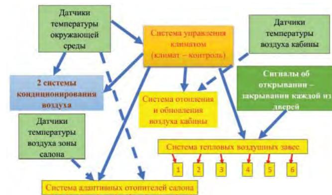
Рис. 1. Упрощённая скелетная схема мультизонаной адаптивной системы климат-контроля
