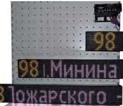
Маршрутный информатор на базе табло с шагом светодиодов модуля 8мм TMC-0630-8Z-1N
