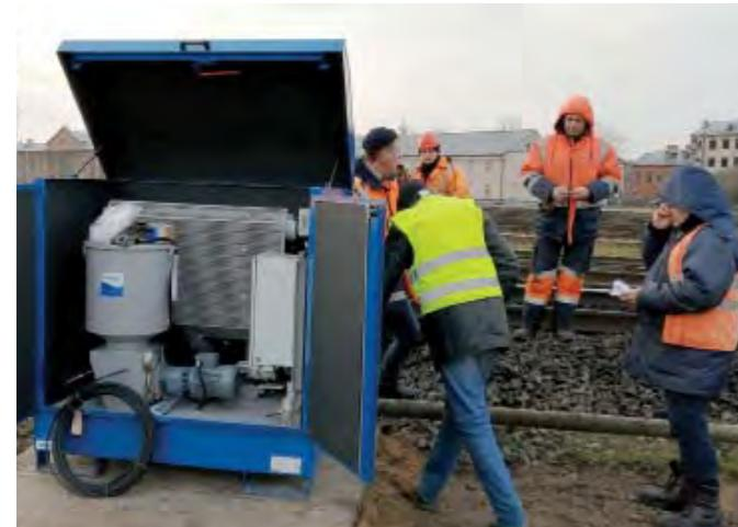
Используемые смазочные материалы не имеют чаще всего достаточной адгезии и необходимого физико-химического состава. Всё это не обеспечивает надёжного и длительного удержания слоя смазки на головке рельса и не создаёт смазочную пленку необходимой толщины.
