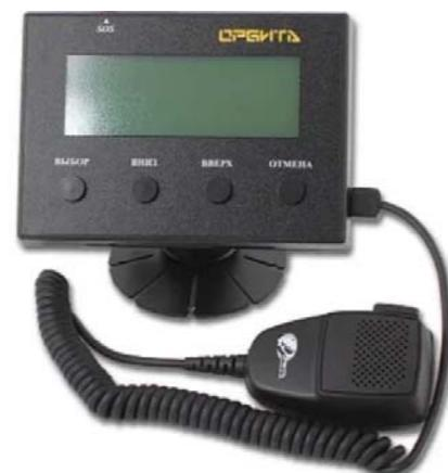
Рис. 2. Применяемый навигационный терминал с дисплеем водителя
