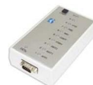
Устройство дистанционного контроля УДК-2 (УДК) размещается на центральном диспетчерском посту (ЦДП) и выполняет опрос РС. По результатам опроса УДК индикирует состояние РС и её неисправность.
