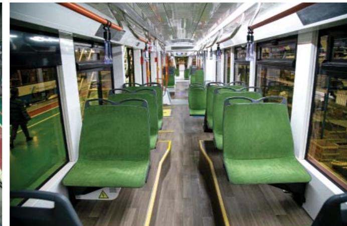
ет ускорить пассажирообмен и делает вагон более комфортным и доступным для маломобильных граждан. Использование алюминиевых сплавов в обустройстве интерьера делает новый трамвай самым пожаробезопасным в своем сегменте, а также износостойким. В салон интегрированы улучшенная система климат-контроля, современные мультимедийные комплексы, USB-розетки, Wi-Fi оборудование, места для людей с ограниченными возможностями здоровья. Стильный дизайн делает «Корсар» настоящим украшением городских улиц.
