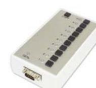
Блок управления резервом БУР (управляющий) размещается на ЦДП и выполняет блоков исполнительных БИ (БИ) или панелей исполнительных и суммирования ПИС-2U-02 (ПИС), установленных на станциях метрополитена
