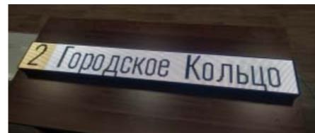
Фото 5.1. Табло TMC-0630-5Z-1-4. Работа в режиме «инверсии», тонкий шрифт
