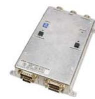
Блок управления резервом БУР (исполнительный) предназначен для подключения к линии поездной радиосвязи (ПРС) метрополитена основной или резервной стационарной радиостанции типа РС 46М Метро с индикацией подключённой радиостанции и возможностью ручного или дистанционного управления.
