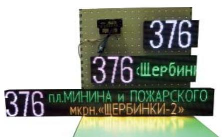
Фото 5. Маршрутный информатор на базе табло, шаг пикселей 6мм TMC-0630-6Z-1-N.
