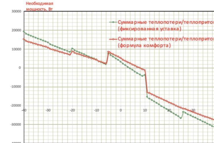
Рис. 9 Температурные зависимости требуемого энергопотребления
