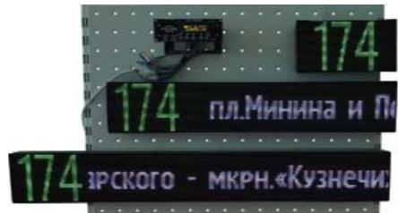
Фото 3. Маршрутный информатор на базе табло, шаг пикселей 4мм TMC0630-4Z-1-N
