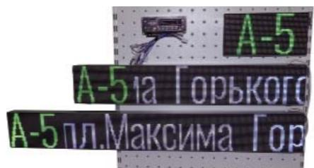
Фото 4. Маршрутный информатор на базе табло, шаг пикселей 5 мм TMC-0630-5Z-1-N
